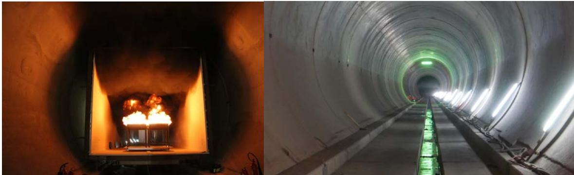
Abb. 2: Links: Blick auf die Brandschutzeinhausung mit 4 brennenden Brandtassen von stromaufwärts Rechts: Heran nahende Rauchfront in der Tunnelröhre stromabwärts
